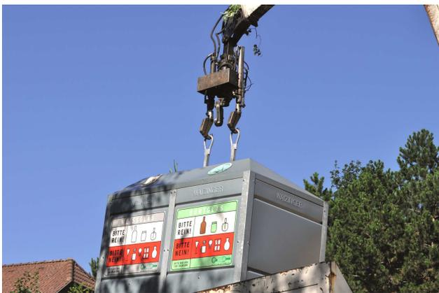
Mit beiden Haken auf den LKW gehoben, werden die einzelnen Kammern des Behälters in die Kammern am LKW (LKW-Aufbau ist zweigeteilt in eine Weiß- und eine Buntglaskammer) entleert.
