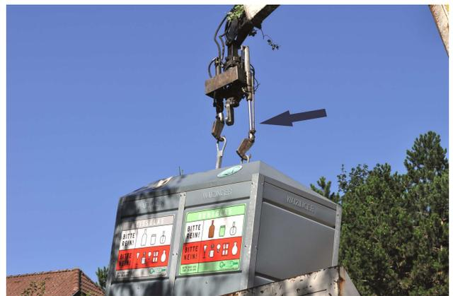
Durch das Runterdrücken des Zylinders wird die Bodenklappe geöffnet und die jeweilige Glasfraktion in die entsprechende Kammer am LKW entleert.
